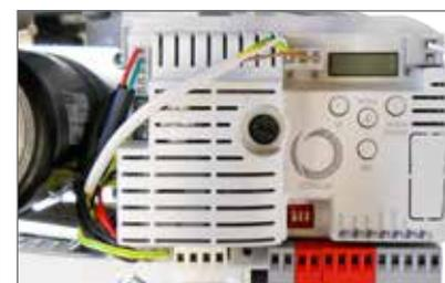
Centrale de commande CT102 24 avec récepteur intégré
